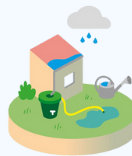
Déraccordement par trop-plein d'une cuve
