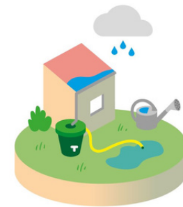
Déraccordement et mise en place d'une cuve
